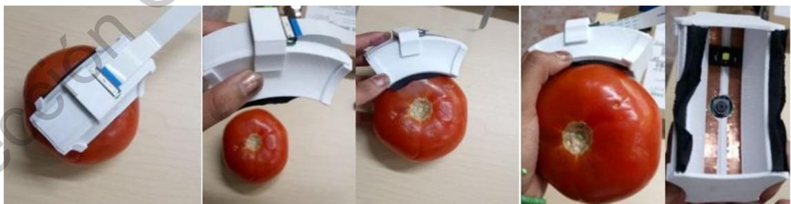
Figura 5.32: Acomodo del jitomate dentro del dispositivo.
