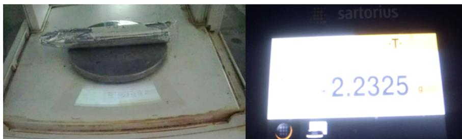
Figura 5.43: Tubo Falcon con muestra de 2 g de jitomate molido.
