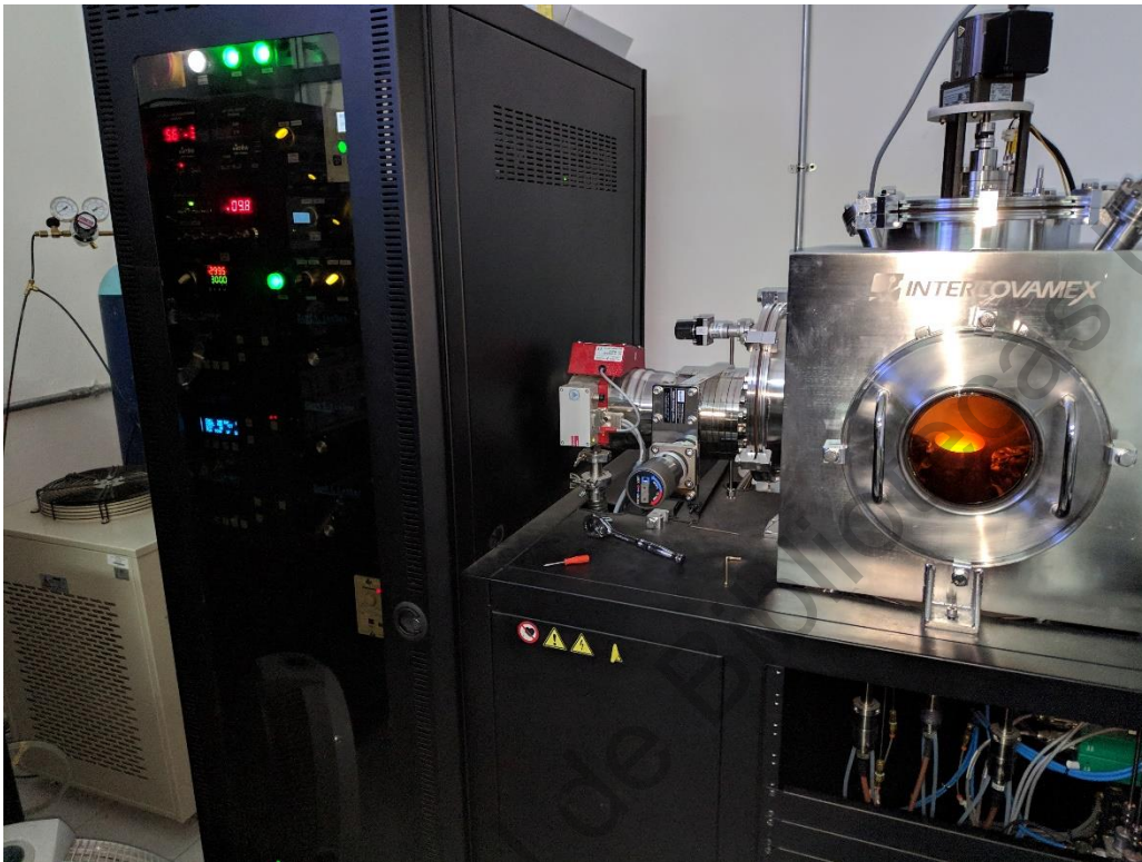
Figura 6.1. Equipo de erosión catódica (sputtering) en etapa de depósito de película de \text{SnO}_2 (plasma luminiscente).
