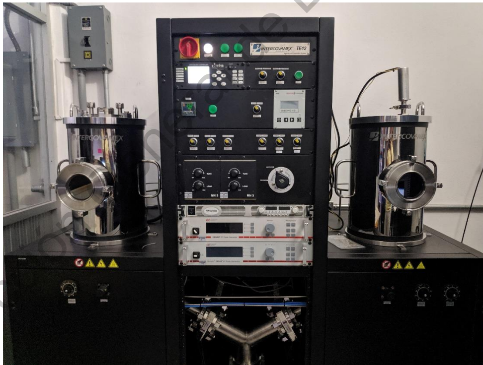
Figura 6.4. Equipo de erosión catódica (sputtering), utilizado para el depósito de contactos.
