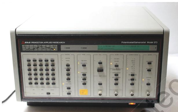
**Fotografía 1.** Potenciostato Princeton Applied Research 273A
