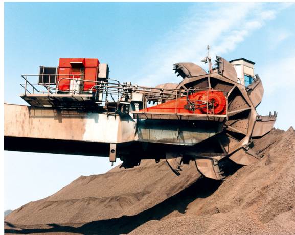
Figura 2.4: Motor de inducción conduciendo un transportador operando a baja velocidad y alto torque.
