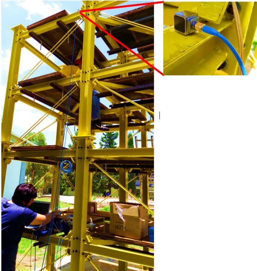
**Figura 7.7.** Instrumentación de estructura con acelerómetros.
