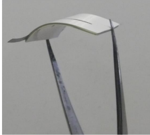
Figura 12. CCM Air-Breathing con estructura de White Polyester Arcare 8259
