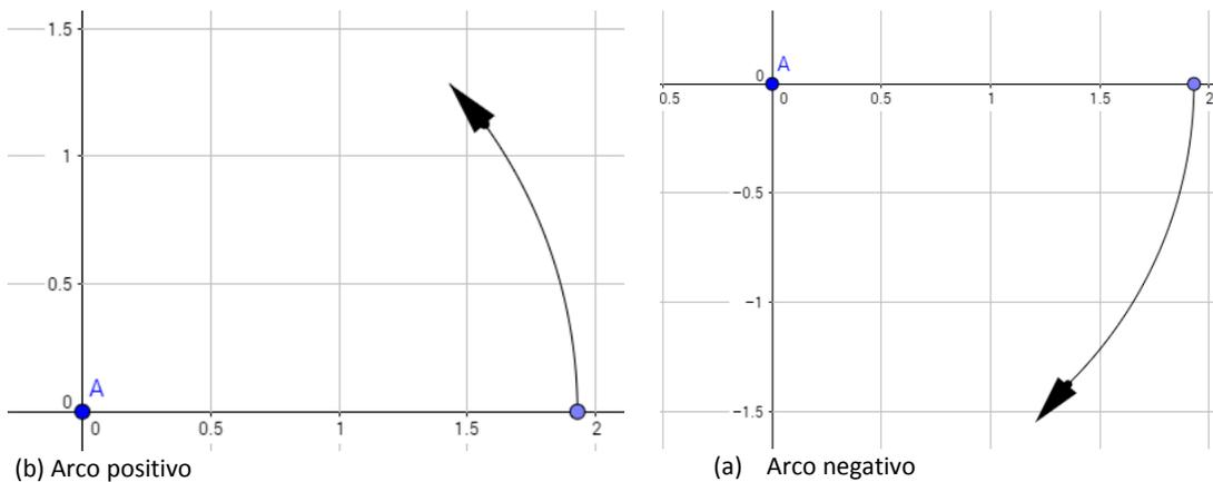
Fig. 24. Interpretación del arco tangente. Cuando el arco tangente resulte positivo, el ángulo debe ser entendido en sentido anti-horario desde el eje  $x$ ; mientras que cuando éste resulte negativo, debe ser entendido en sentido horario desde el eje  $x$ .
