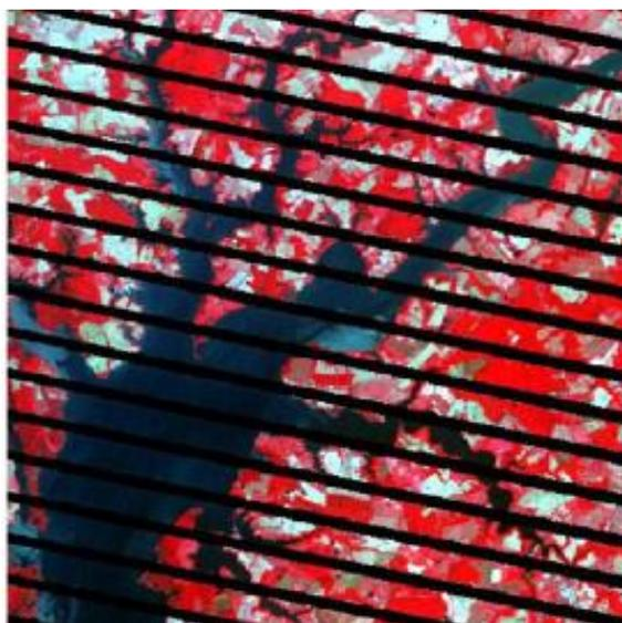
Figura 4-10 Ejemplo de la presencia de bandeado en una imagen satelital (Fuente: Chen, Zhu, Vogelmann, Gao, & Jin, 2011).
