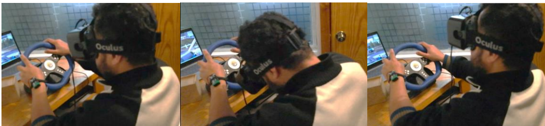
Figura 7.32. Pruebas con usuario a) usuario antes de la presencia de somnolencia, b) momento en que se detecta somnolencia, c) usuario después de que la alarma fue activada.
