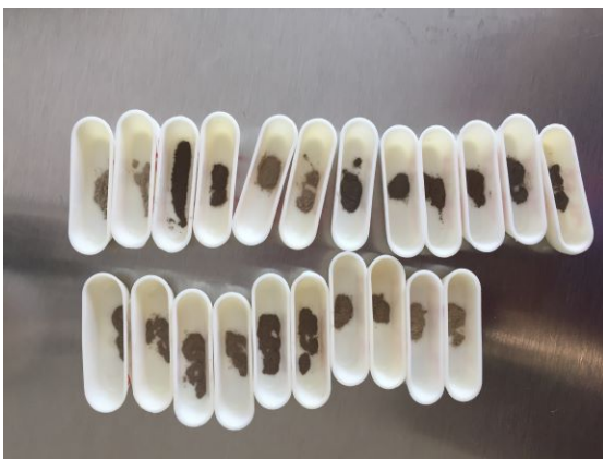
Figura 12. Medición de carbono total de las muestras de suelo en el laboratorio CALAGUASS-MAGIC.
