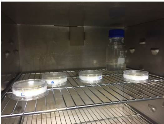
Figura 13. Sembrado, cultivos y lectura de muestras de agua para coliformes fecales y totales, en el laboratorio de CALAGUAS-MAGIC.
