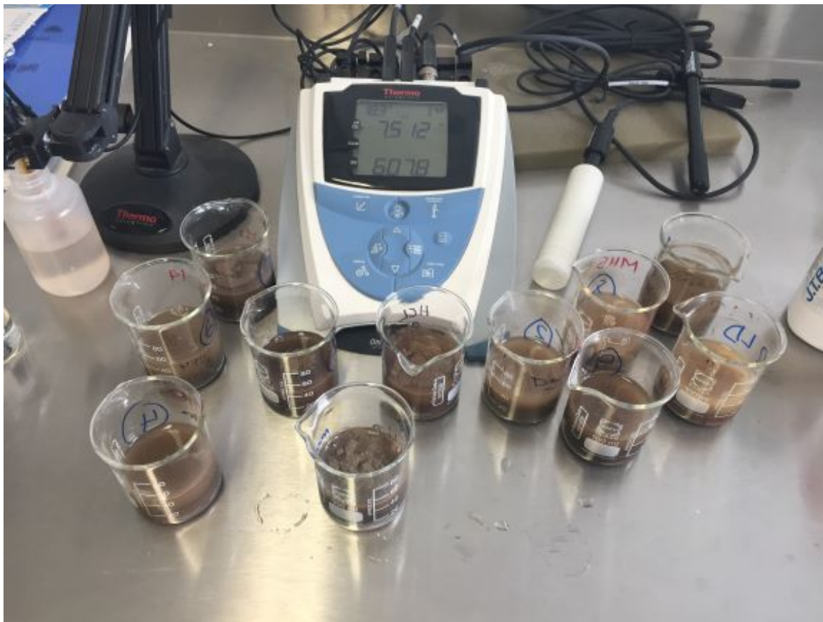
Figura 8. Determinación de pH de muestras de suelo en el laboratorio CALAGUAS-MAGIC
