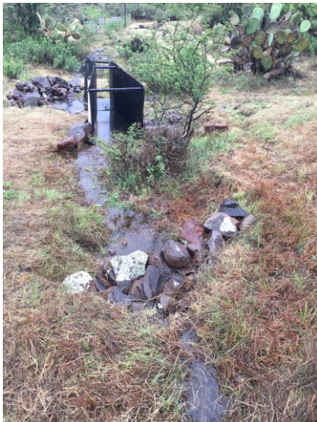
Figura 14. a) Aforador Parshall en punto de salida de la unidad con manejo y obras, ejido San Marcos de Begoña. b) Aforador Parshall en punto de salida de la unidad de escurrimiento control del ejido San Marcos de Begoña.
