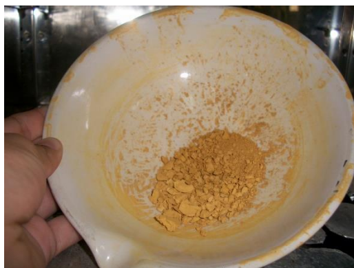
Figura 5. Materia prima para la elaboración de membranas goethita sintética
