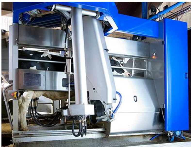
Figura 1 Sistema de ordeño robotizado (AMS)
