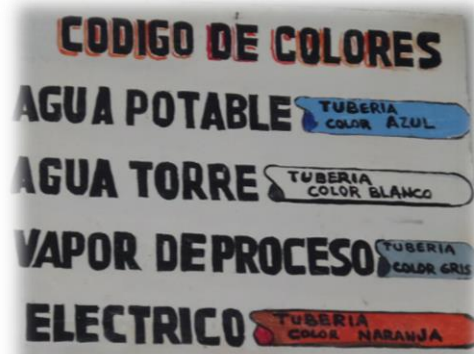
Figura 3 Código de colores para tuberías propio de la planta productora
