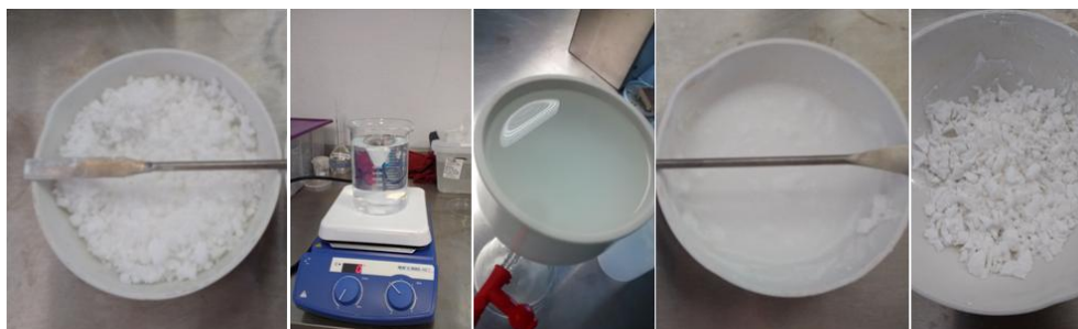
Figura 7.1 Proceso de dopaje de la SBA-15 con grupos funcionales amino.
