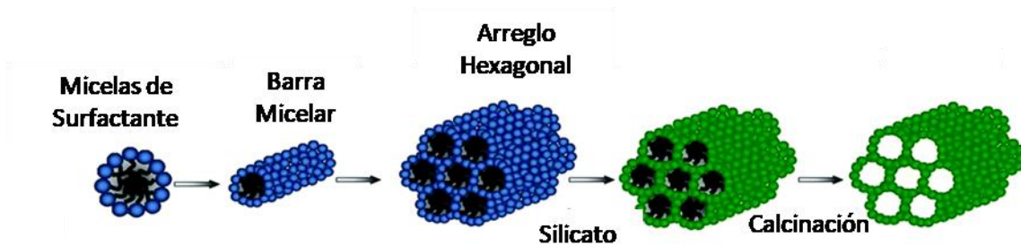
Figura 3.3 Formación de estructuras de sílice (Prasomsri et al., 2015).
