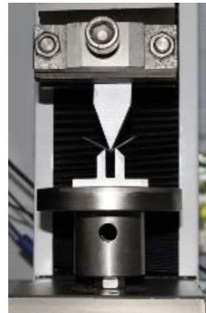
Figura 11. Aplicación de una carga en el centro de la muestra mediante el punto de carga.
