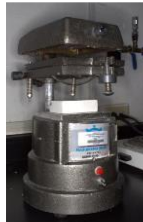
Figura 7. Calentamiento del acetato para su posterior succión al vacío
