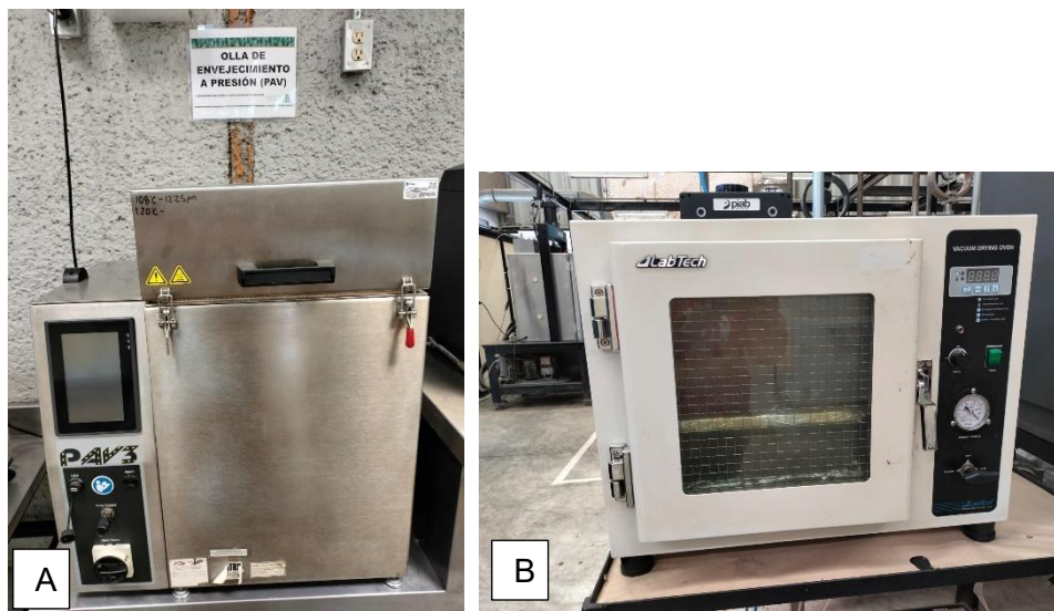
Figura 3. (A) Olla de envejecimiento a presión PAV, (B) Horno de secado al vacío.
