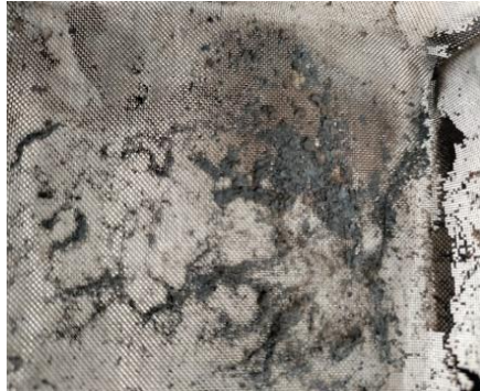
Figura 18. Presencia de material fino en tamiz.
