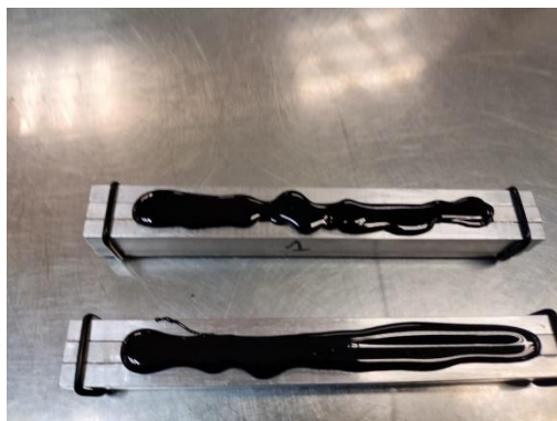
Figura 36. Elaboración de vigas.
