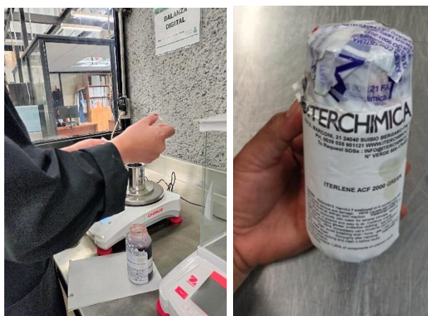
Figura 39. Adición de aditivo Iterlene ACF 2000 Green (Ad-2).
