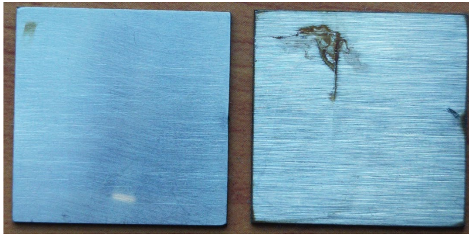
Figura 18.- Placas de acero sin recubrimiento tras 36hrs en niebla salina.
