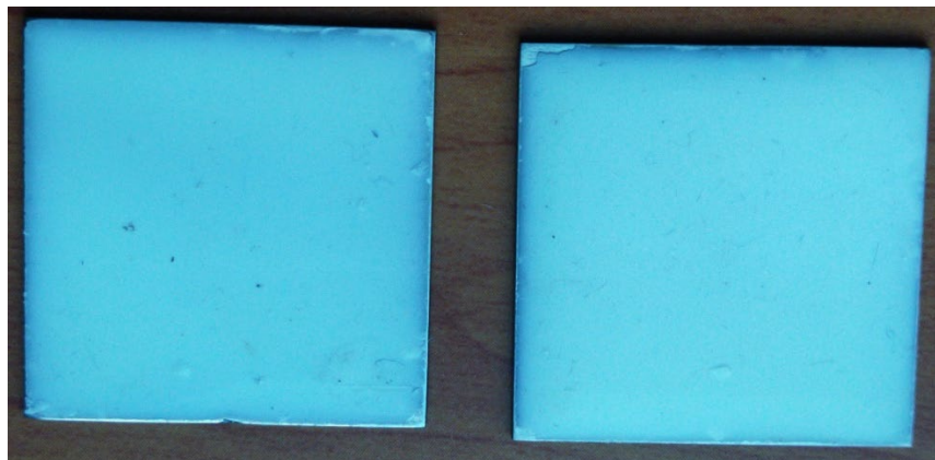
Figura 22.- Placas de acero con recubrimiento 3% tras 36hrs en niebla salina.
