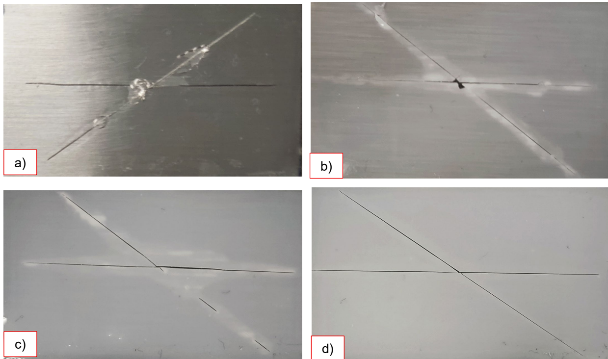
Figura 16.- Evidencia fotográfica representativa del ensayo de adhesión por cinta para recubrimientos PDMS/TiO 2 : (a) 0 % TiO 2 , (b) 1 % TiO 2 , (c) 2 % TiO 2 y (d) 3 % TiO 2 , tras la remoción de la cinta adhesiva.
