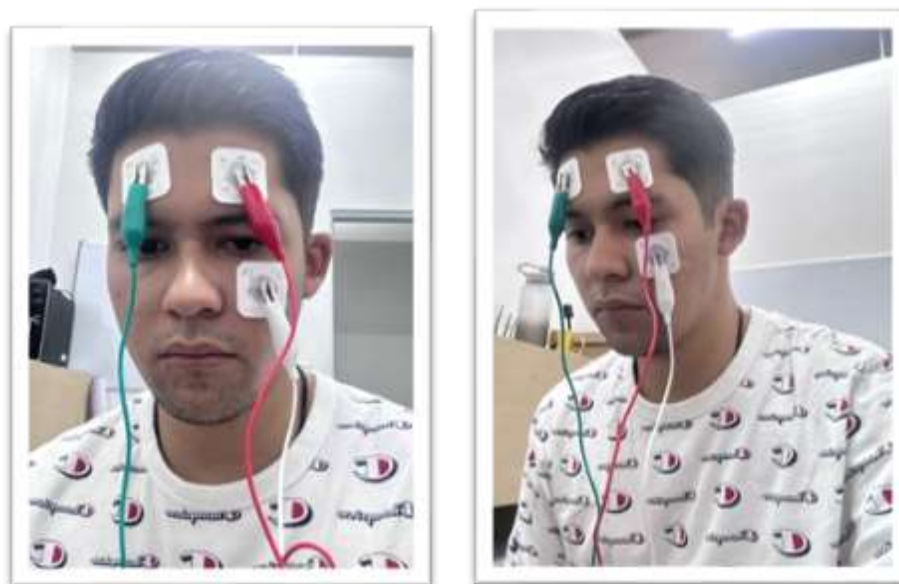
Fig. 13. Referencia de colocación de los electrodos para pruebas.
