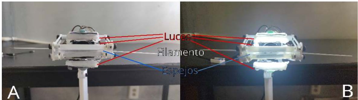
Figura 11: Vista frontal del prototipo de inspección. A) Sistema inactivo. B) Sistema de iluminación LED encendido. (Autoría propia)
