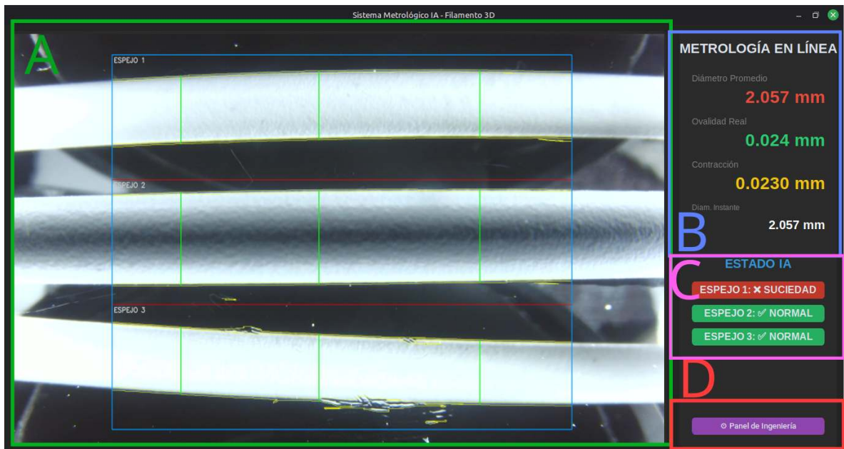
Figura 17: Distribución funcional de la ventana principal. A) Renderizado de video en tiempo real. B) Panel de metrología. C) Semáforos de inferencia de IA. D) Acceso a configuración. (Autoría propia)
