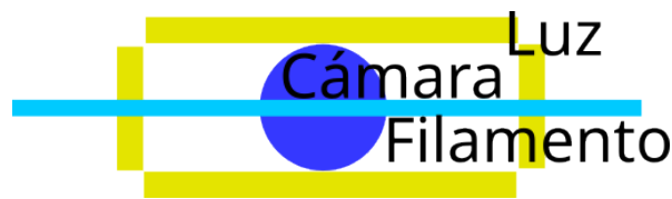
Figura 3: Vista frontal sin espejos del sistema de adquisición de imágenes del diagrama de luces, cámara y el filamento. (Autoría propia)
