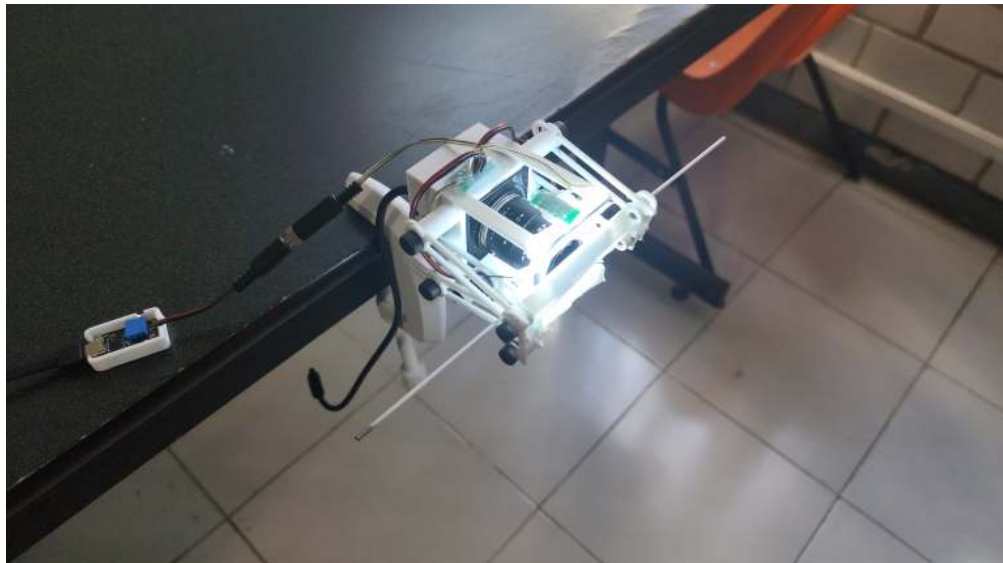
Figura 7: Montaje experimental para la adquisición del conjunto de datos. Se aprecia la calibración del sistema de iluminación indirecta y el arreglo catóptrico durante el paso del filamento. (Autoría propia)
