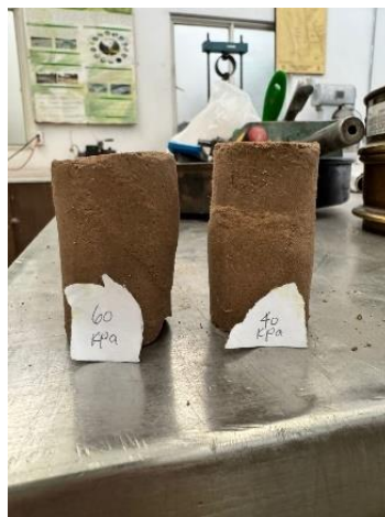
Figura 49. Falla en probetas.
