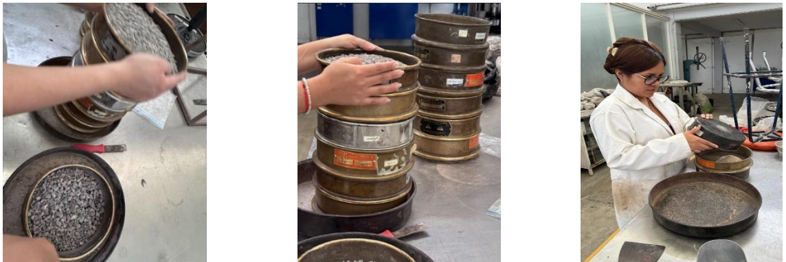
Figura 32. Procedimiento de cribado.
