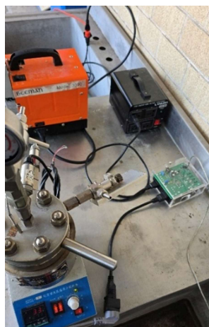
Figura 28: Sistema de medición de energía montado con reactor
