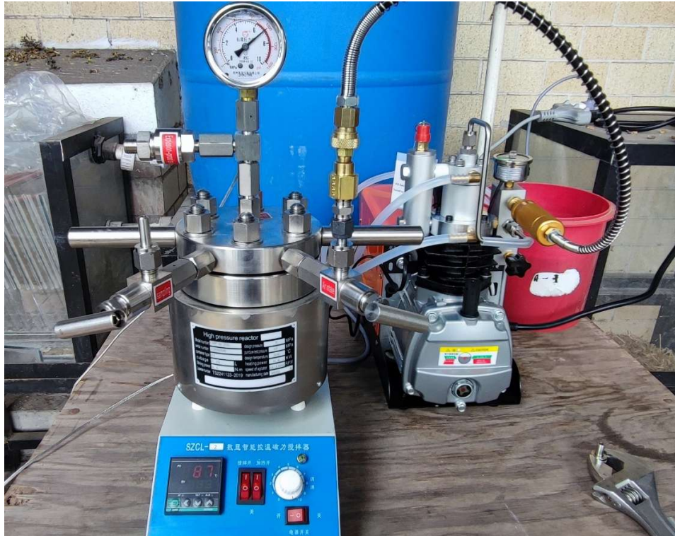
Figura 7: Reactor con compresor de CO 2
