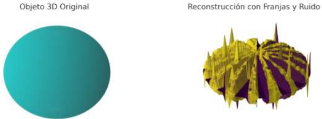
Figura 1. Ejemplo de reconstrucción de objeto 3D con y sin ruido. La imagen ilustra la comparación entre un objeto 3D original (una esfera) y su reconstrucción simulando la técnica de proyección de franjas. La reconstrucción muestra franjas y ruido (picos), representando irregularidades en los datos de imagen. Imagen generada por ChatGPT de OpenAI.
