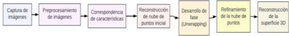
Figura 3. Diagrama del proceso de reconstrucción 3D.
