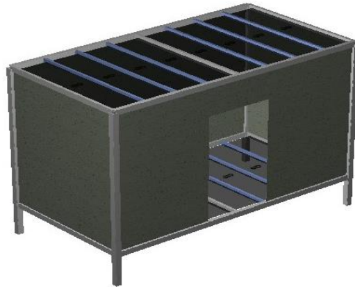
Figura 2-1.- Unidad modular donde las cargas gravitacionales se transfieren a través de las paredes laterales.
