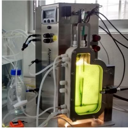
Figura 4. Fotobioreactor Algaemist-S. Cultivo a escala laboratorio con 390 ml de capacidad aproximadamente.
