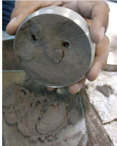
Figura 6-XVIII. Probeta de suelo después de la falla.
