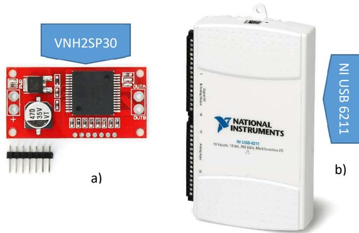
Figura 4.10. Módulo VNH2SP30 (a), NI USB 6211 (b).
