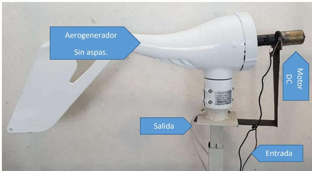
Figura 3.11. Aerogenerador y motor acoplados.
