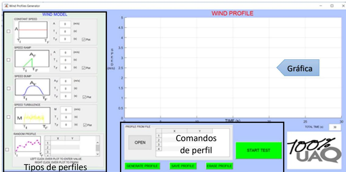
Figura 3.2. Software de generación de perfiles de viento.
