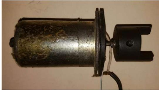
Figura 3.9. Motor de DC, 12 voltios y 2 amperes.
