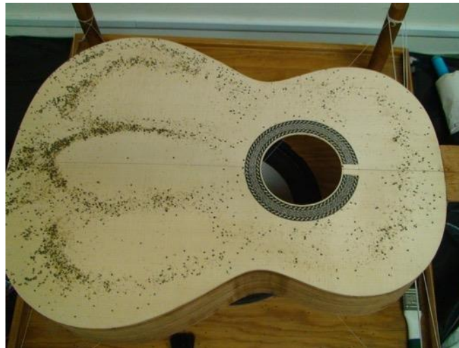
Figura III.IX. Patrón generado por frecuencias en tapa acústica de guitarra. Fuente: Elaboración Propia.
