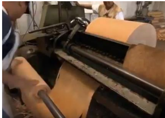
Figura V.IV Fotografía de máquina para la elaboración de contrachapado. Fuente: Taller la Española Paracho Michoacán
