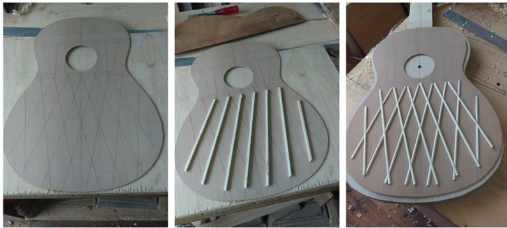
Figura V.XXXIV Seguimiento de la elaboración de propuesta de varetas en taller de laudería
