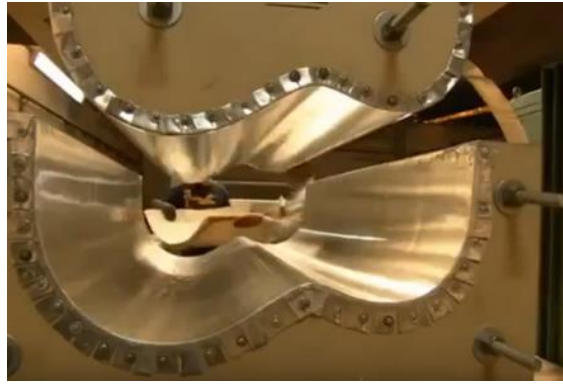
Figura V.V. Fotografía de prensa para doblado de madera. Fuente: Taller la Española Paracho Michoacán
