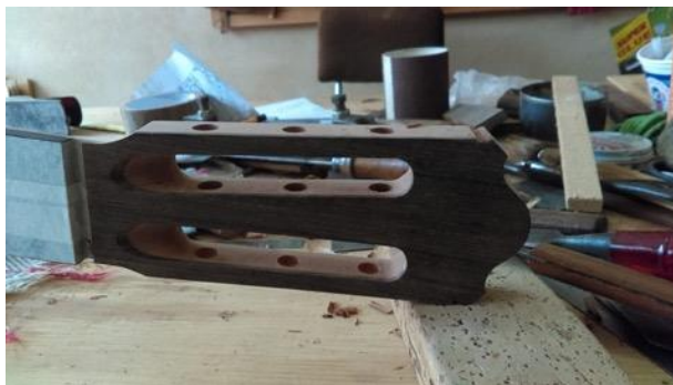
Figura V.XXXVI Fotografía de la preparación del clavijero.
