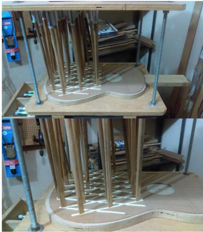
Figura V.XXXV Fotografía del proceso de pegado de varetas modelo propuesto
