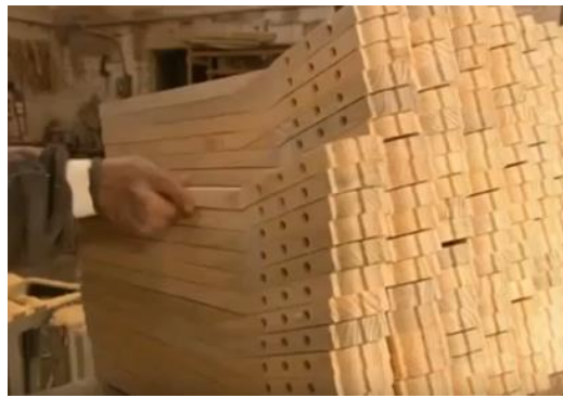
Figura V.VI Fotografía de la elaboración del mástil en masa. Fuente: Taller la Española Paracho Michoacán.
