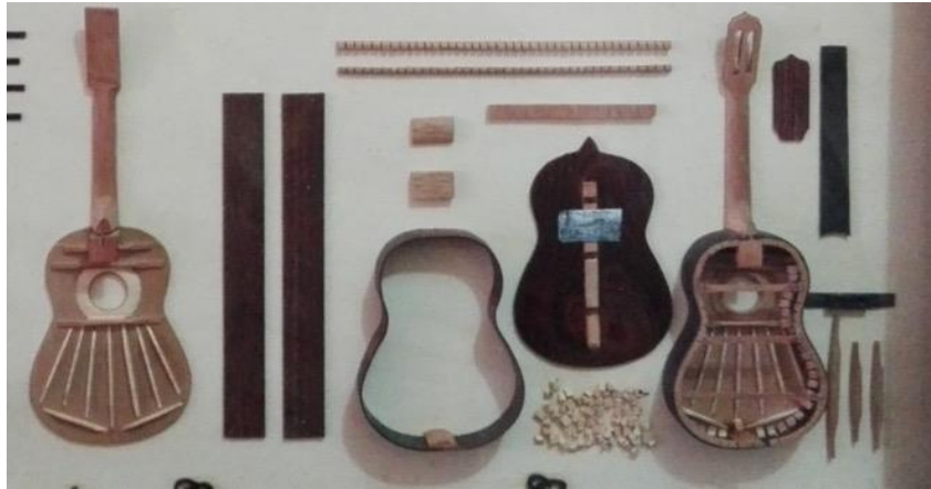
Figura III.VI Fotografía de una representación escala 1:7 del despiece de la guitarra tipo torres elaborada en la región de Paracho Michoacán. Fuente: German Maldonado, Laudero
