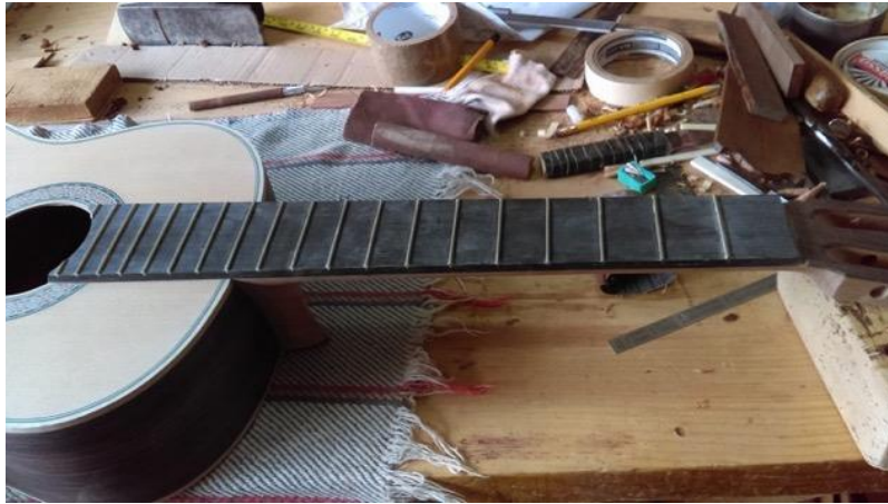
Figura V.XXXVII Fotografía del ensamble de los trastes.
