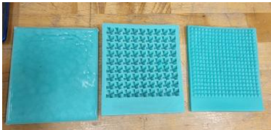
Figura 11. Probetas para utilizarse en la caracterización del AER en los transductores ultrasónicos para fisioterapia (fuente propia).
