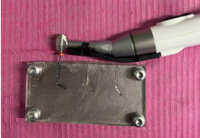
Fig 6. Prueba de resistencia a la fatiga cíclica en platina de acero inoxidable en angulación 30°.
