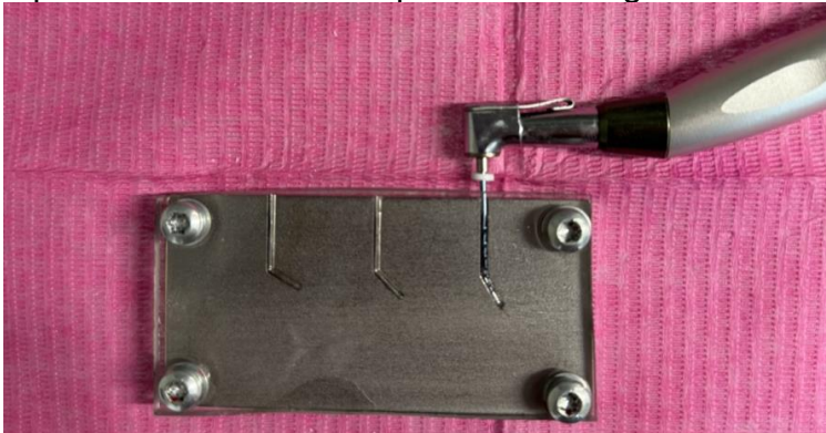
Fig 9. Prueba de resistencia a la fatiga cíclica en platina de acero inoxidable en angulación 60°.
