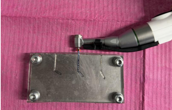
Fig 8. Prueba de resistencia a la fatiga cíclica en platina de acero inoxidable en angulación 45°.
