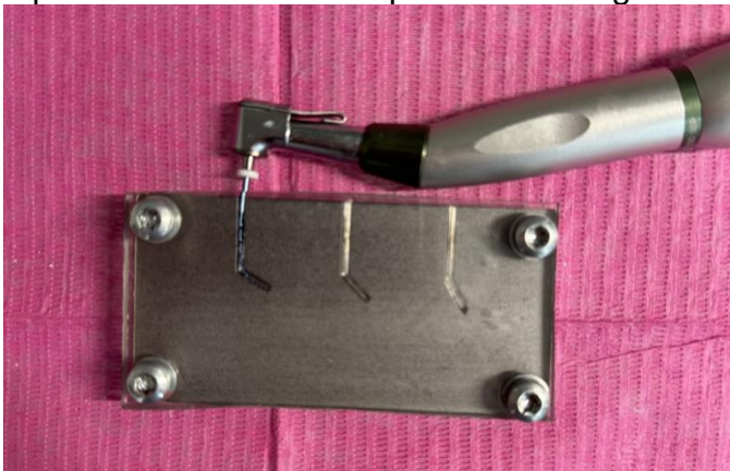
Fig 5. Prueba de resistencia a la fatiga cíclica en platina de acero inoxidable en angulación 30°.
