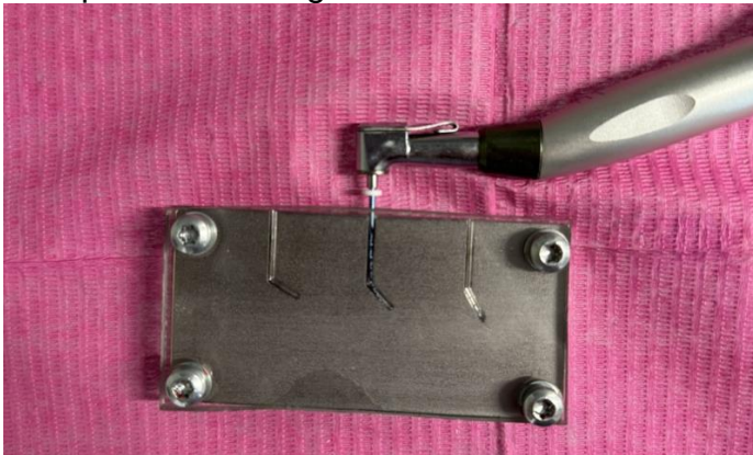
Fig 7. Prueba de resistencia a la fatiga cíclica en platina de acero inoxidable en angulación 45°.
