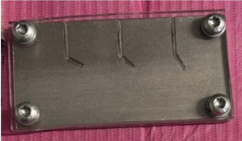
Fig 1. Matriz metálica de acero inoxidable (conductos de 30°, 45° y 60°) y con tapa de cristal que permite la visibilidad del instrumento durante la prueba.
