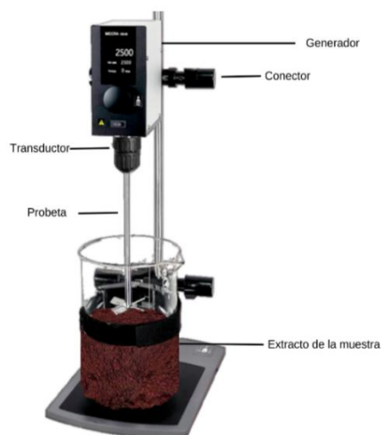
Figura 6. Sistema de extracción asistido por ultrasonido de probeta aplicado a una mezcla sólido-líquido. Fuente: elaboración propia.
