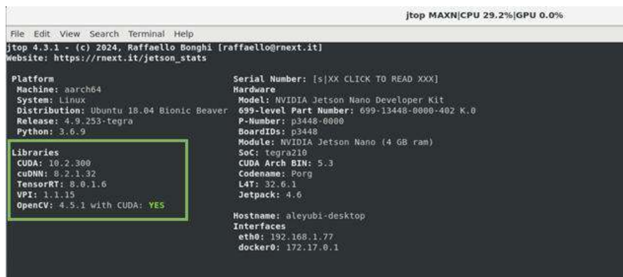
Figura 36. Configuración correcta de OpenCV con CUDA:
