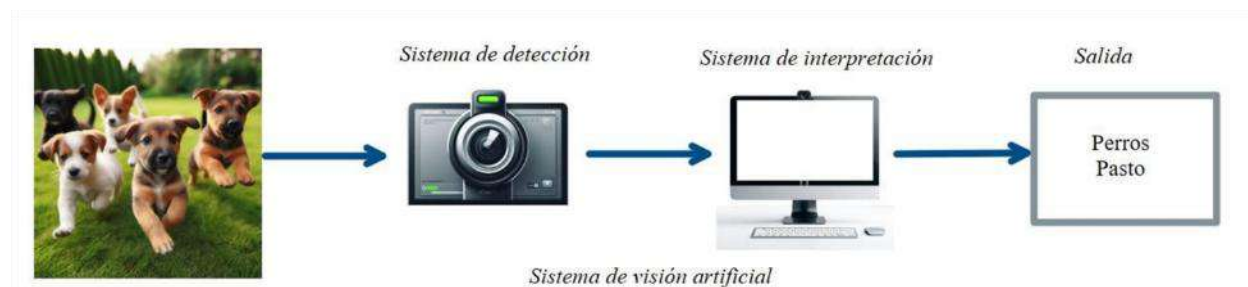
Figura 11. Sistema de visión por computador. Adaptado de Generador de imágenes de Microsoft Designer por
