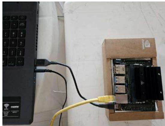
Figura 8. Conexión de la tarjeta Jetson Nano a la computadora
