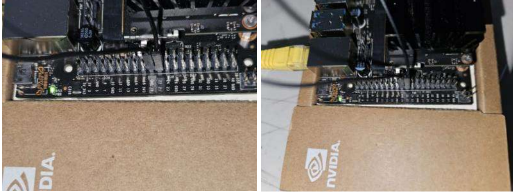
Figura 29. Conexión del pin 19 a pin 21, haciendo cortocircuito.
