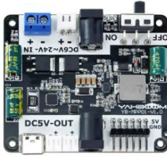
Figura 5.8: Tarjeta de expansión de alimentación para Raspberry Pi 5 .
