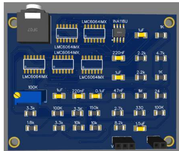
(b) Modelo 3D de la PCB de adquisición.
