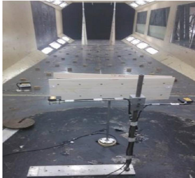
Figura 2.9. Modelo aeroelástico de un AEU con mampara desfasada en forma de “V”, extraído de Li, et al. (2018)
