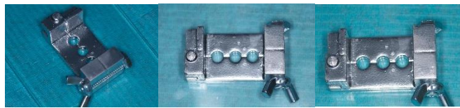
Figura 1. Molde de aluminio para la fabricación de especímenes.
