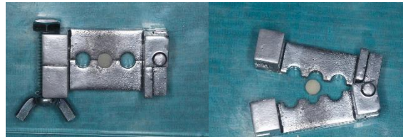
Figura 14 retiro de muestras del molde de aluminio.
