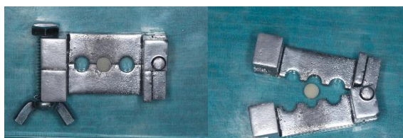
Figura 10 retiro de muestras del molde de aluminio.
