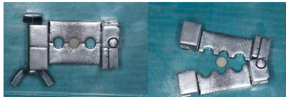
Figura 6 retiro de muestras del molde de aluminio.
