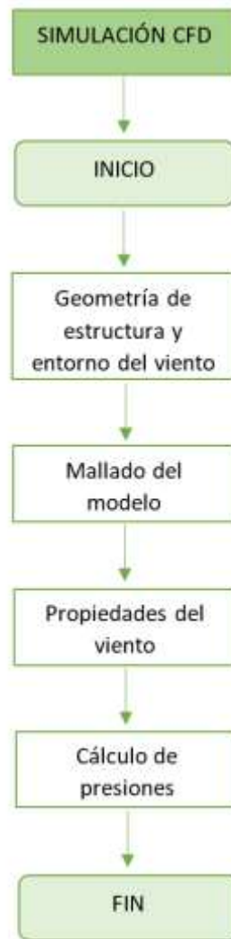
Figura 4.2 Descripción de la simulación CFD.
