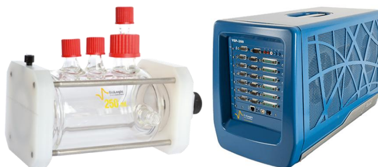
Figura 28. Celda electroquímica y potenciostato.
