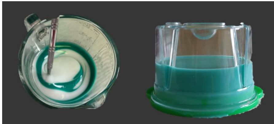
Figura 3. Mezclado de silicona en partes iguales y colocación de la silicona dentro de la mufla de plástico.
