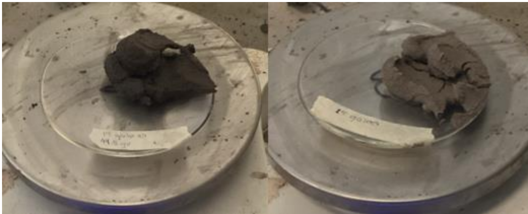
Figura 17. Determinación de Límite Líquido por el método de la copa de Casagrande.
