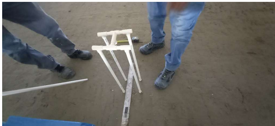
Figura 13. Sembrado de la estructura en el perfil de arena.
