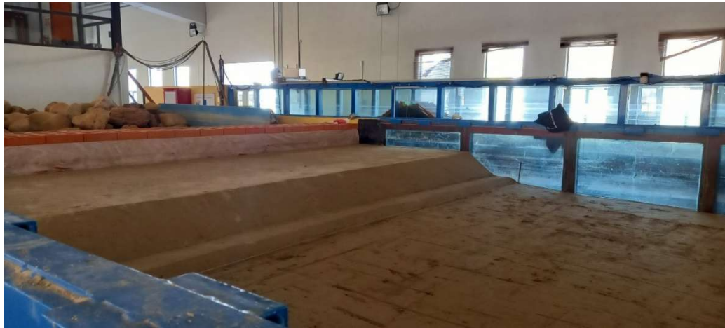
Figura 11. Preparación del canal y construcción de la pendiente de arena.
