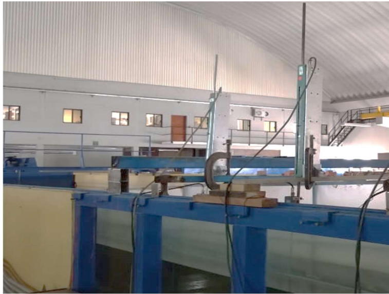
Figura 10. Sensores de tipo resistivo utilizados para medir la altura de ola incidente y reflejada.
