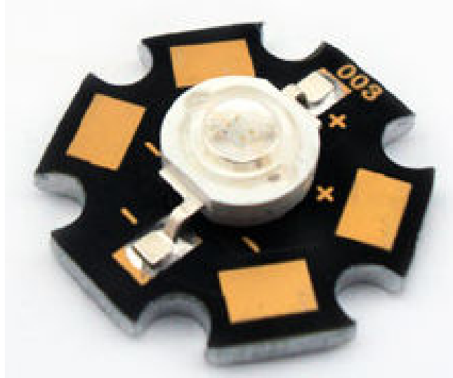
Figura 3-2 Led ultravioleta de 395 \text{ nm} de 5 watts de potencia utilizado para excitación de fluorescencia
