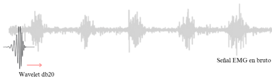
Figura 3.20: Comparación entre la wavelet madre db20 y la señal EMG original.
