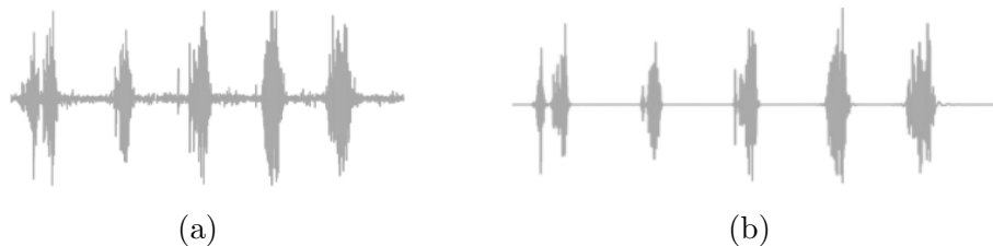
Figura 3.22: Comparación entre las señales del movimiento de flexión: (a) Señal bruta, y (b) Señal procesada.
