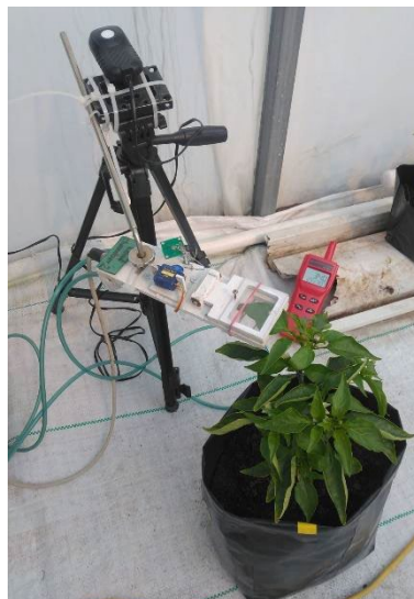
Figura 4. Cámara de intercambio de gases conectada a monitor para la estimación de fotosíntesis, transpiración, conductancia estomática e índice de presión de vapor.
