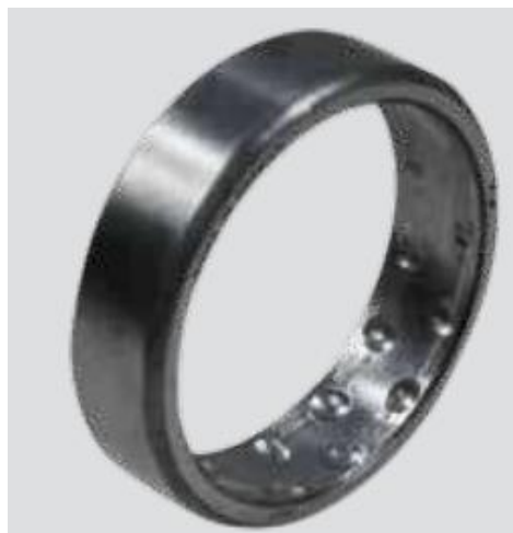
Figura 7 Vibro corrosión severa en camino de rodadura en un rodamiento de bolas (SKF, 2017).
