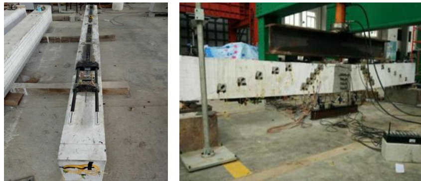
Figura 3. Proceso de carga en la viga reforzada con fibra de carbono y cables de acero (Zhu et al., 2020).
