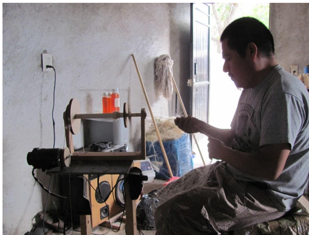
Imagen 22. Torno de hilar eléctrico para hilo fino hechizo. En la foto Don Pedro Vega. Barrio Santa María. Fotografía Fernando Valadez Soto, marzo 2023.
