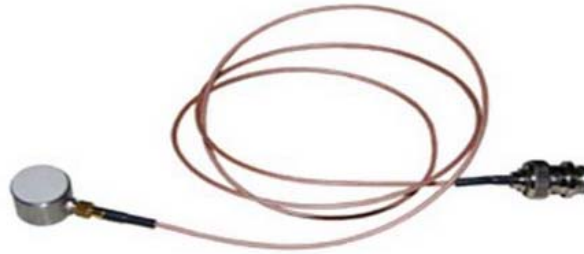
Figura 3.2 Sensor de emisión acústica fabricante: Soundwel (Fuente: https://www.soundwelshop.com/ )
