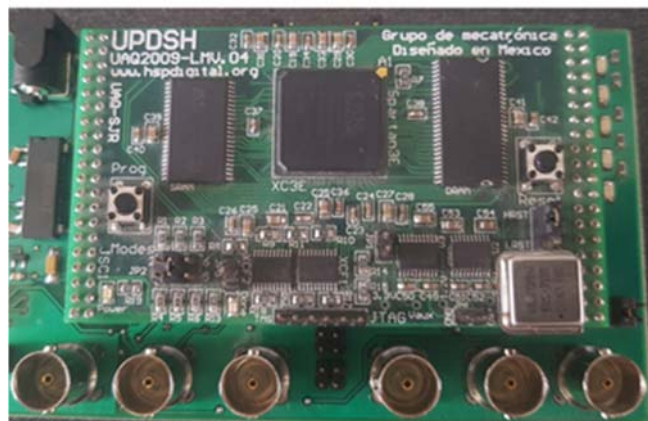
Figura 3.13 Tarjeta de adquisición con tarjeta UPDSH
