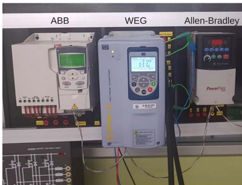
Figura 4.6 Variadores de Frecuencia
