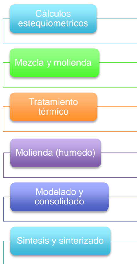
Figura 15. Diagrama de los pasos más importantes en la síntesis de compuestos por reacción en estado sólido.
