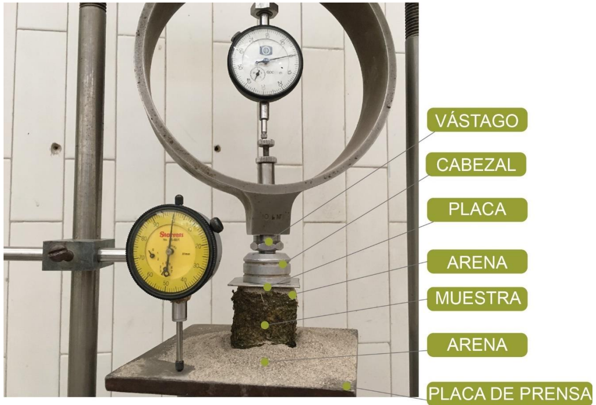
Figura 4.3.8 Colocación de muestra en compresor. Fuente: Fotografía de autoría propia.
