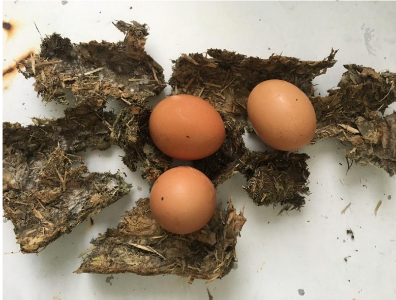
Figura 4.8.1 Resultado de prueba de tránsito en mesa vibratoria. Fuente: Fotografía de autoría propia.
