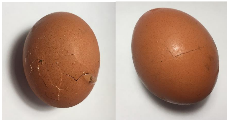
Figura 4.8.2 Daños en huevos después de la prueba de transporte. Fuente: Fotografía de autoría propia.
