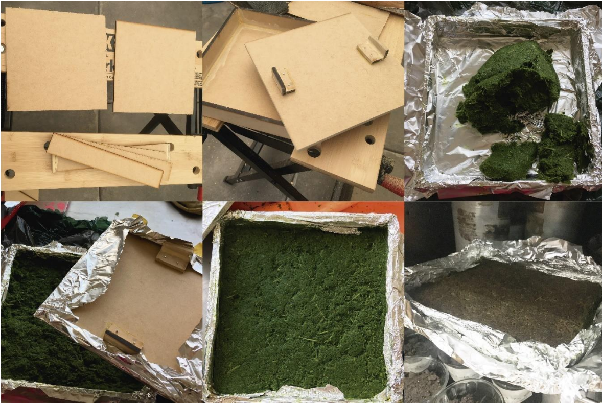
Figura 4.3.10 Fabricación y acondicionamiento de material sobre probeta.
