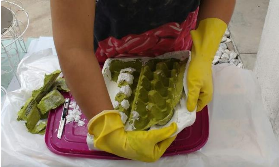
Figura 4.7.2 Proceso de desmolde. Fuente: Fotografía de autoría propia.
