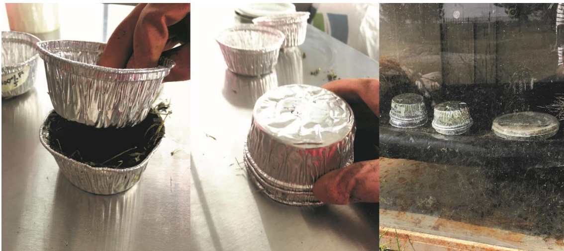
Figura 4.1.6 Moldeo y exposición al calor de muestras. Fuente: Fotografía de autoría propia.
