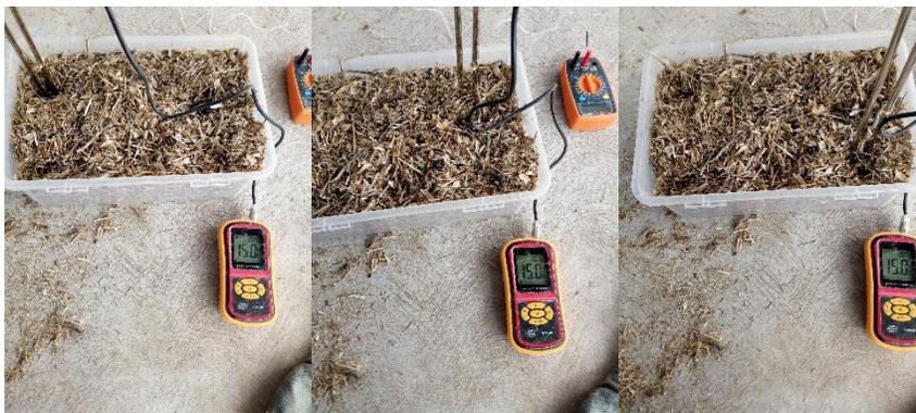
**Figura A1. 4.** Experimento Criba 12.7 mm y Humedad Inicial de 15.0 %.
