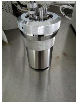
**Figura 15.** Bomba de oxígeno del calorímetro isoperibólico.
