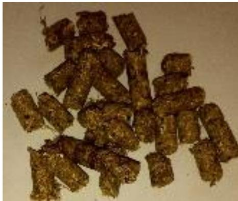
**Figura 16.** Pellets de con 8.50 % de humedad inicial.
