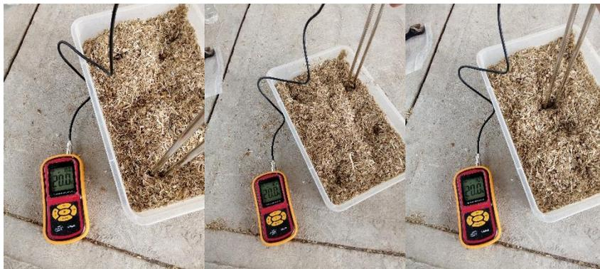
**Figura A1. 2.** Experimento Criba 8.00 mm y Humedad 20.0 %.
