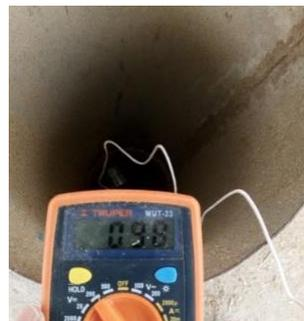
**Figura 19.** Medición de la temperatura en la matriz de formado.
