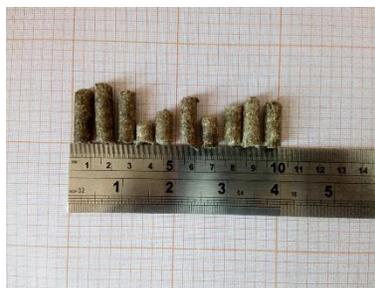
**Figura 59.** Pellets de biomasa al 20.0 % de humedad inicial y criba de 8.0 mm.
