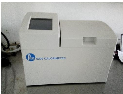
**Figura 9.** Calorímetro 6200, utilizado para determinar el poder calorífico superior.
