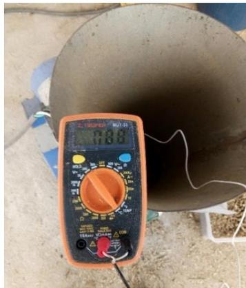
**Figura 11.** Multímetro con termopar.
