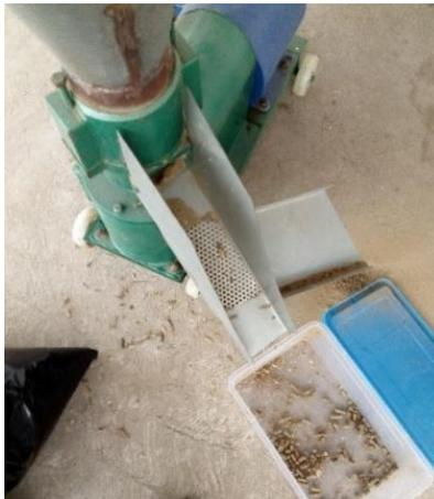
**Figura 17.** Proceso de densificado, etapa de limpieza y enfriado.
