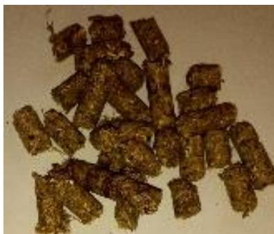
**Figura 21.** Pellets de segunda prueba, elaborados con humedad inicial de 8.5 % y criba de 3.97 mm.
