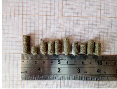
**Figura 62.** Pellets elaborados con humedad inicial de 15.0 % y tamaño de partícula de 3.97 mm.
