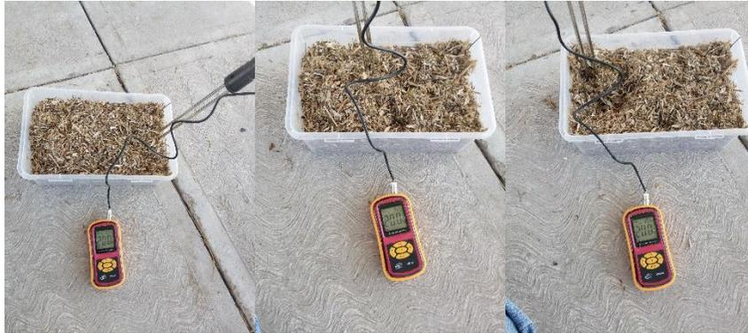
**Figura A1. 1.** Experimento con la criba de 12.7 mm y la humedad inicial de 20.0 %.
