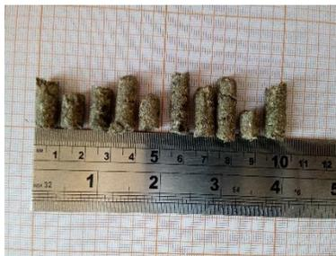
**Figura 64.** Pellets elaborados con humedad inicial de 10.0 % y tamaño de partícula de 8.00 mm.
