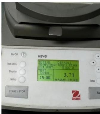
**Figura 14.** Termo balanza marca OHAUS.
