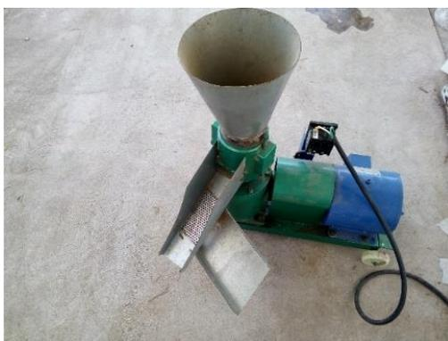
**Figura 7.** Pelletizadora o densificadora de rodillos.
