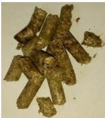
**Figura 22.** Pellets de segunda prueba, elaborados con humedad inicial de 15 % y criba de 3.97 mm.
