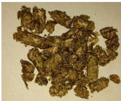
**Figura 23.** Aglomerados obtenidos con criba de 1 pulgada de diámetro a humedad inicial de 20 %.
