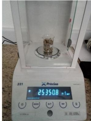
**Figura 10.** Balanza Precisa 321, empleada para determinar los pesos individuales y granel de los pellets.
