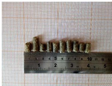
**Figura 63.** Pellets elaborados con humedad inicial de 15.0 % y tamaño de partícula de 8.00 mm.
