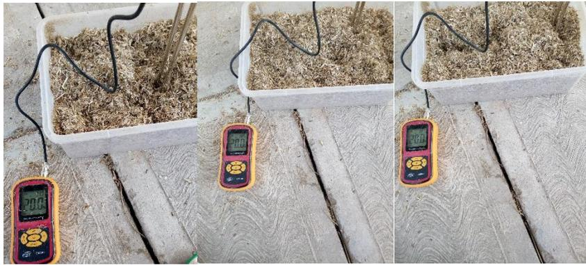
**Figura A1. 3.** Experimento Criba de 3.97 mm y Humedad 20.0 %.
